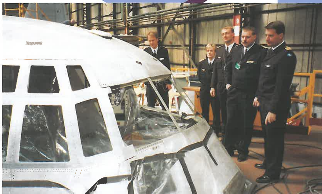
Försvarsmaktspersonal besökte i våras Marshall i Cambridge. Här studeras hur spruckna fönsterramar byts på TP 84 cockpit. Personerna på bilden är fr v: Övlt Lars Axelsson HKV KRI UH samt övlt Ingela Mathiasson, övlt Hans Tillander, mj Stefan Järkeborn och öv Fredrik Hedén från F 7.
